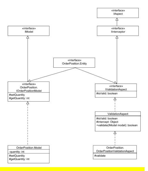
Abb. 1: Diagramm der Klasse OrderPosition aus dem ersten Beispiel.
